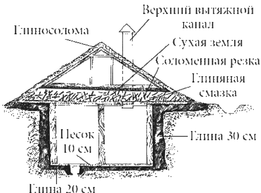
Рисунок 77. План полуподземного омшаника
