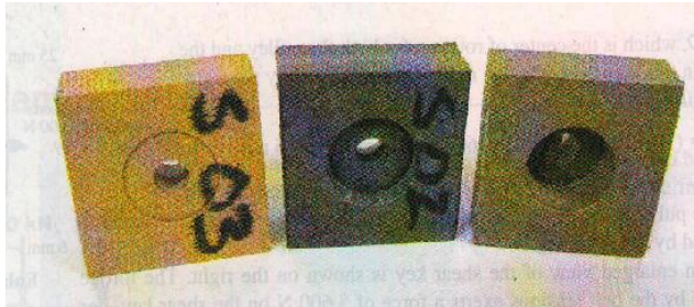
ნახ. 1.5. გამოწნეხითი ძვრა ხის ნიმუშებზე
