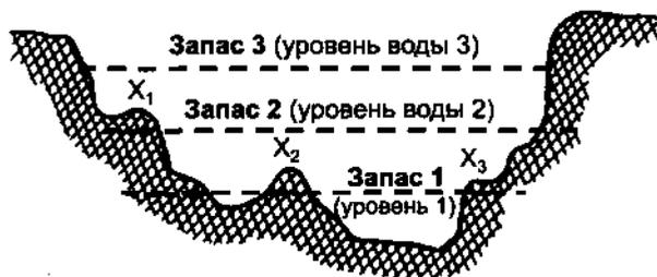
Рис. 36. Функция улучшения (кайдзен) системы канбан.
