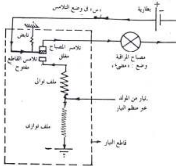
شكل يوضح الدائرة الكهربائية لمصباح مراقبة المولد في وضع مضى وذلك في حالة عدم دوران المولد أو لعب بالقاطع ( جهد البطارية أكبر من جهد المولد )
