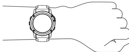
**REMARQUE** : le capteur de fréquence cardiaque est situé à l'arrière de l'appareil.
