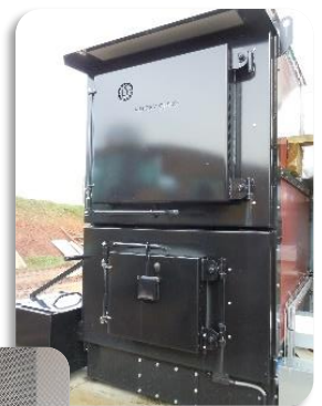
Générateur d'Air chaud au bois déchiqueté
