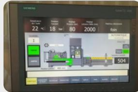
L'automate permet entre autres de régler la densité et la hauteur des balles
