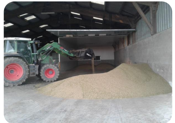
Remplissage d'une cellule avec godet
