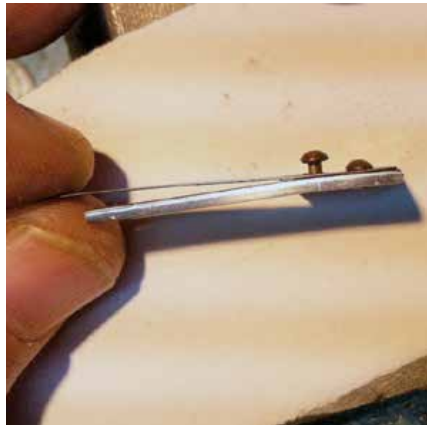
Sollevezione del rivetto.
