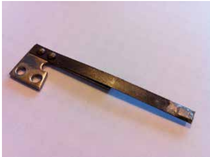
La molla non appoggia per tutta la lunghezza del supporto, appare rialzata.
