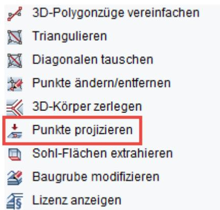
Diese neue Funktion projiziert 3D Geländepunkte in Z-Richtung (Höhe) auf eine Baugrube. Somit ist es sehr einfach, beliebige Punkte im Gelände mit der Höhe anzuschreiben.
