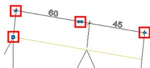
Sie können den Abstand ändern, durch die Achse verschieben oder an den Ecken den Winkel der Masslinie ändern. Es stehen Ihnen verschiedene Symbole zur Verfügung.
